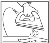
Drücken Sie die Taste (A), um Dampf auszustößen. Dampfbügeln ist möglich, wenn der Drehknopf auf Wolle ●● oder Baumwolle-Leinen steht ●●●.
