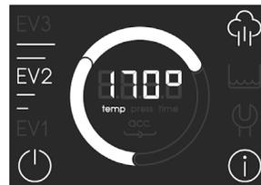
Der Kreis wird als Indikator ausgefüllt, wenn die Dampfmenge EV1, EV2, EV3 erhöht wird.
