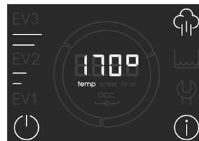
Sobald der Betriebsdruck erreicht ist, erscheint dieser auf dem Display (4). Auf diese Weise zeigt das Gerät an, dass es bereit für den Gebrauch ist.
