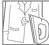
Der Dampfausstoß ist unabhängig von der Neigung des Bügeleisens. Daher kann der Dampf auch zum Auffrischen von Vorhängen, Kleidung und Stoffpolstern durch vertikales Bügeln verwendet werden.
