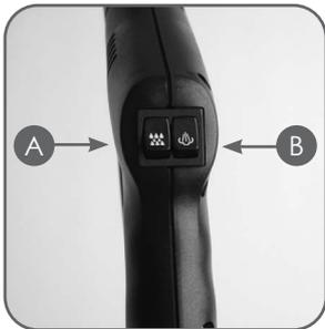
Sie können die Dampfmenge durch Drücken der Taste (B) regulieren. Ohne Symbol, kleine, mittlere, große Dampfmenge.
